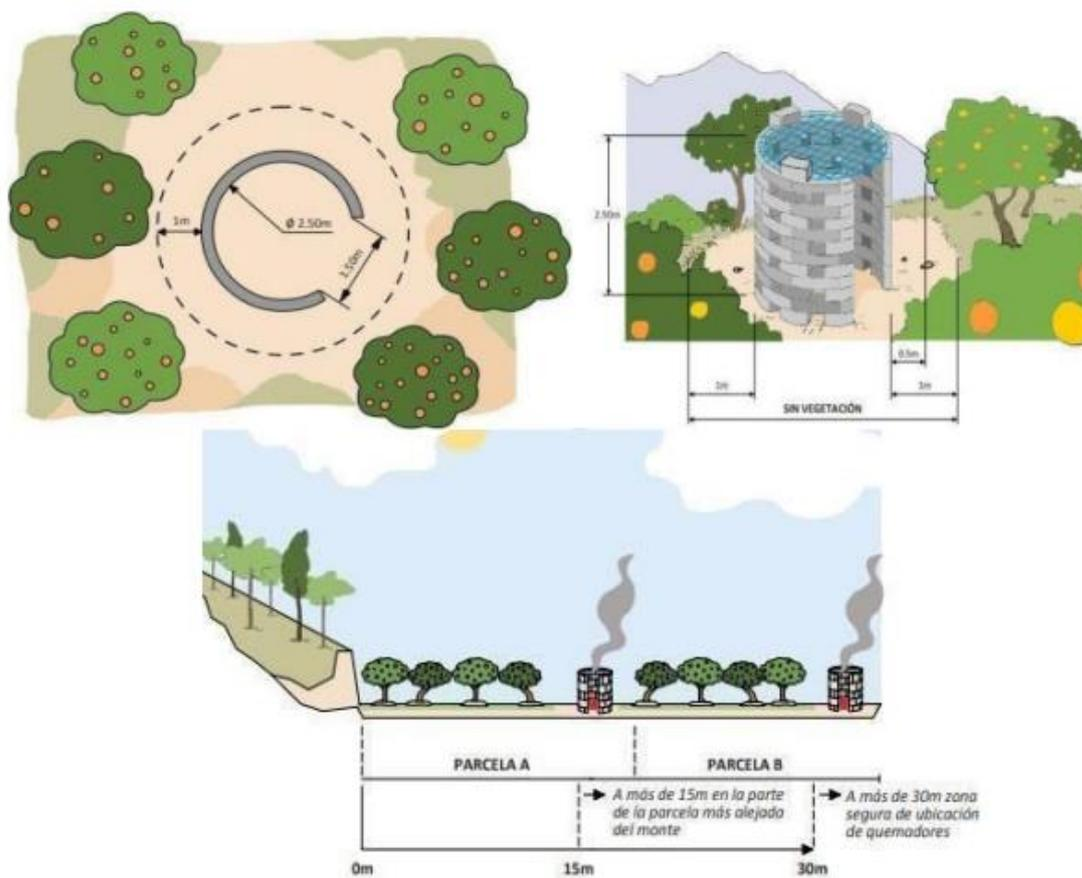
Figura 27. Norma técnica de quemadores agrícolas. Fuente: GVA, 2015.
